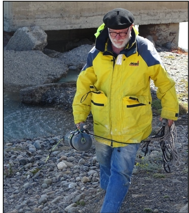
Figura 27 - Tomando una muestra de agua desde el Puente de la Ruta 40, usando la botella Niskin, con disparo desde la superficie
