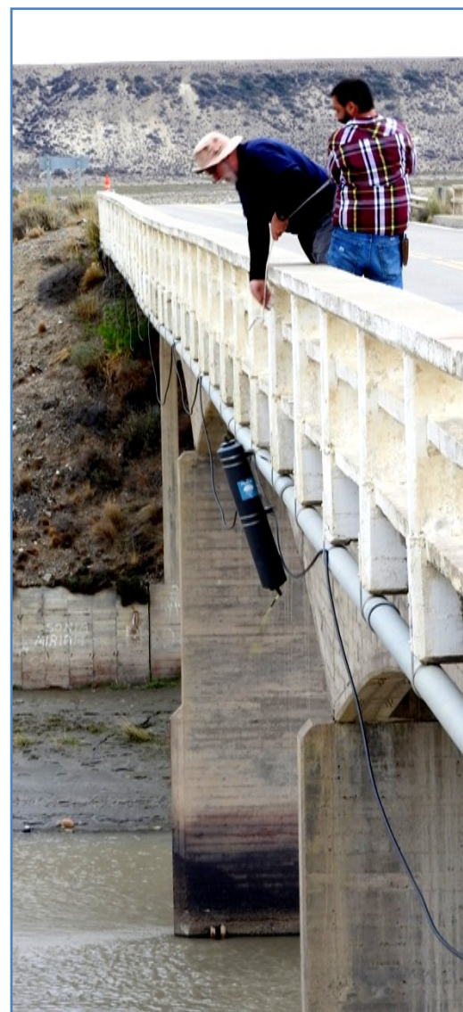
Figura 11 - Tomando la muestra de agua con botella Niskin.
