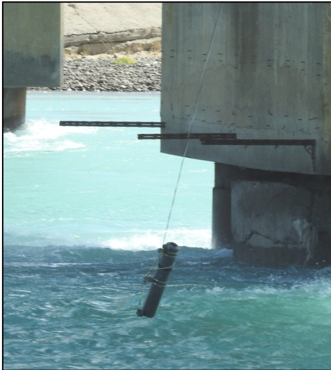
Figura 27 - Tomando una muestra de agua desde el Puente de la Ruta 40, usando la botella Niskin, con disparo desde la superficie
