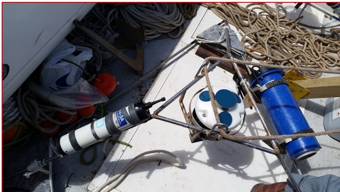
Figura 04 - El implante completo con el equipo ADCP AWAC de 600 kHz (transductores azules), su contenedor de baterías (cilindro azul), y el equipo CTDTu OBS 3A, listo a ser fondeado en el Punto Estuario.
