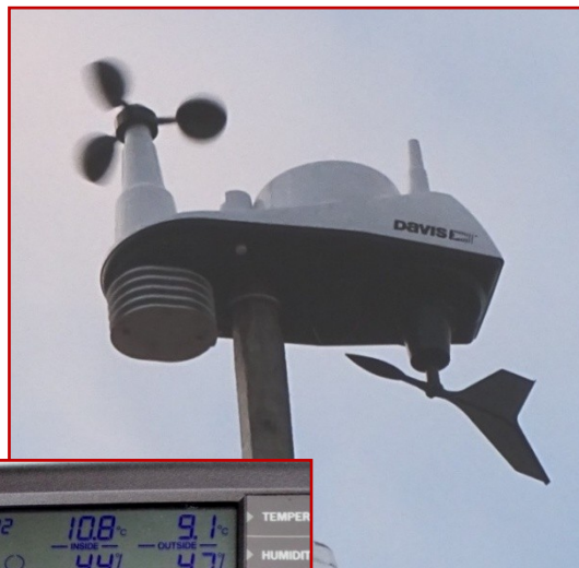
Figura 17 - Abajo: La estación funcionando, en su torre. Derecha: La unidad de sensores, en el tope de la torre, y la unidad de registro
